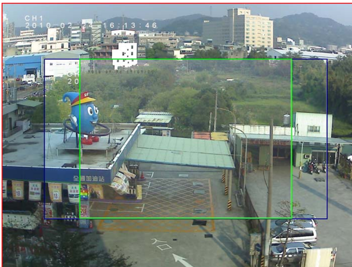
Angolo di vista reale dello stream 1 a 1600x1200, 1280x720 and 960x720
