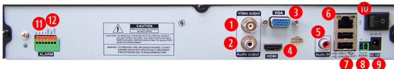
1 – USCITA BNC – Uscita monitor BNC per collegare un monitor di tipo PAL da TVCC analogica eppure l'ingresso AV di un televisore. Si tratta di una porta monitor ausiliaria in risoluzione standard PAL, assai inferiore alle altre uscite video VGA e HDMI. Se ne consiglia l'uso pertanto solamente a fini tecnici e non come monitor principale.
