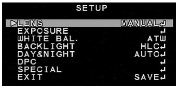
Le telecamere dispongono di numerose funzioni programmabili che si configurano attraverso un menu a schermo (OSD). La pulsantiera di controllo per il menu è posta lungo il cavo di connessione della telecamera dove si trova un mini joystick che permette di muoversi fra le opzioni e confermare le scelte.
