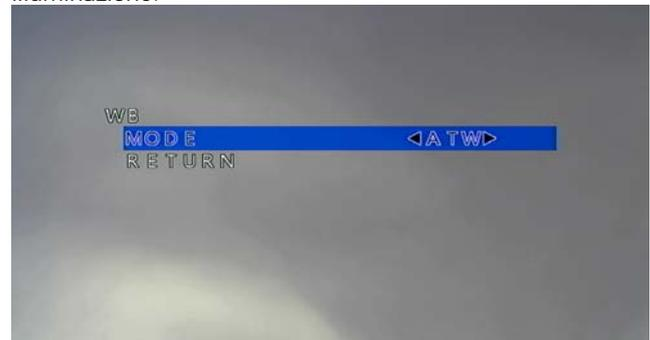
Le opzioni di bilanciamento del bianco sono MODE ATW (il bilanciamento del bianco viene automaticamente regolato al variare della tipologia di illuminazione) e MODE MWB (impostazione manuale del bilanciamento del bianco modificando i valori nelle voci RGAIN e BGAIN)
