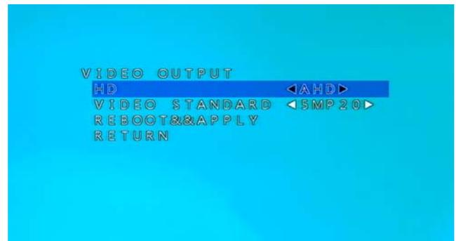
Le voci del menu su cui agire sono HD, per scegliere la tecnologia (AHD, TVI, CVI, CVBS); VIDEO STANDARD, per scegliere la risoluzione (5MP20, 5MP12.5, 4MP25, 4MP30, 4MP15, 1080P25, 1080P30); REBOOT & APPLY, per confermare i settaggi impostati e riavviare la telecamera con i nuovi settaggi.
