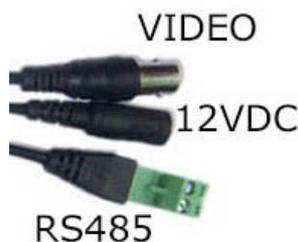
**Uscita video BNC** – Al connettore BNC femmina a baionetta si collega il cavo video che si porta poi verso monitor o dispositivi di gestione in genere tramite cavo coassiale tipo RG59 e connettore BNC.
