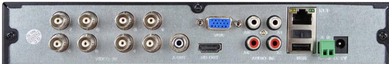
**VIDEO IN** – A questi ingressi video di tipo BNC puoi collegare qualsiasi tipo di telecamera analogica in tecnologia AHD, CVI o TVI, fino a risoluzione 8MP. Puoi anche collegare vecchie telecamere analogiche CVBS. Le uniche telecamere con connessione BNC che non puoi collegare sono le telecamere digitali SDI.
