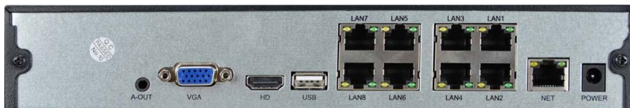
**A-OUT** - A questo connettore minijack puoi collegare un altoparlante esterno per diffondere l'audio del DVR. Ricorda che l'uscita monitor HDMI conduce anche l'audio per cui se colleghi una TV via HDMI puoi sentire l'audio senza collegare questa uscita.
