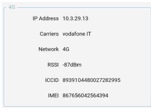
Nella sezione 4G devi vedere indicato il nome del gestore a cui sei collegato, con l'indirizzo IP che ti è stato assegnato. Controlla anche il livello del segnale 4G (RSSI) che **non deve superare -60**. In questo esempio sopra il segnale è troppo basso, -87dBm e questo potrebbe causare mancanza di connessione dati.
