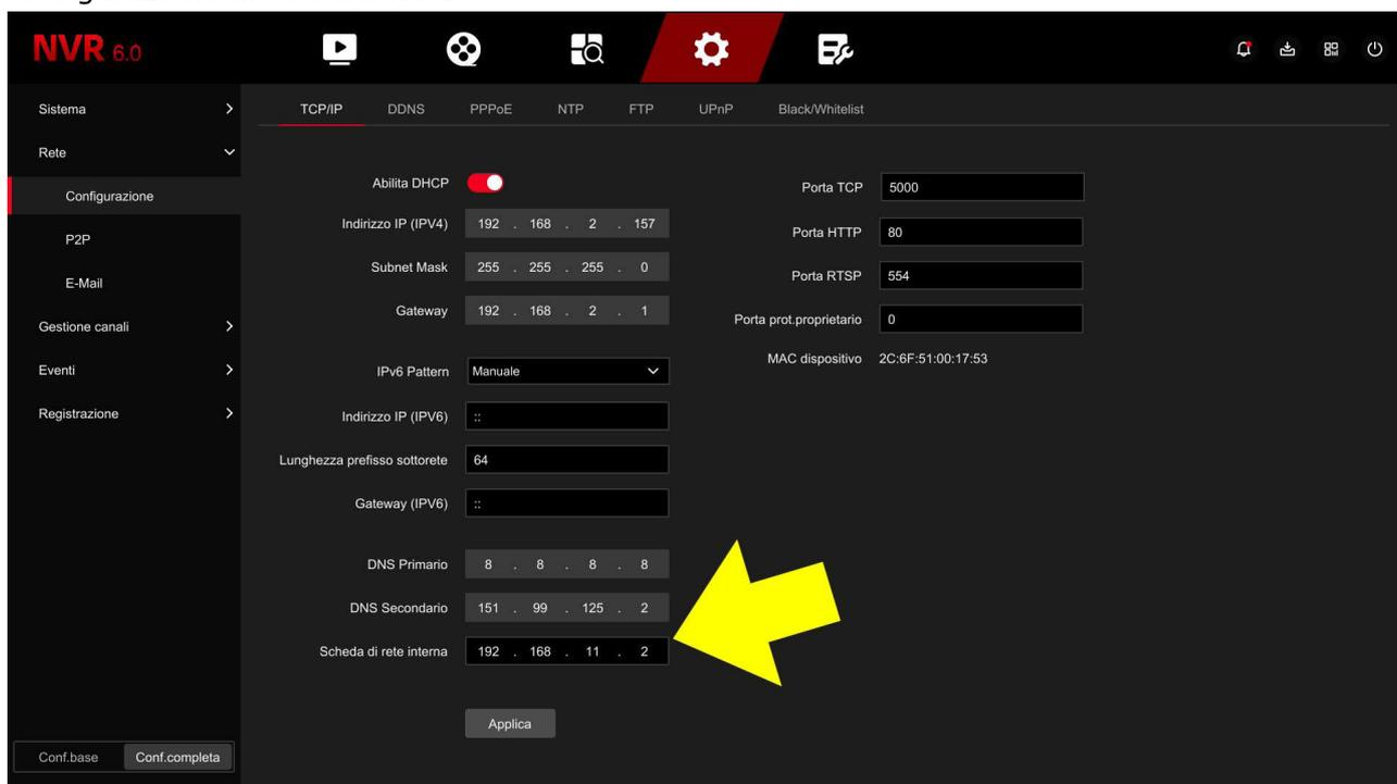
Una volta assegnato l'IP alla telecamera, collega la telecamera a una porta POE del NVR, apri GESTIONE CANALI e clicca il pulsante AGGIUNGI MANUALMENTE, inserendo i parametri corretti di connessione alla telecamera, come nel seguente esempio
