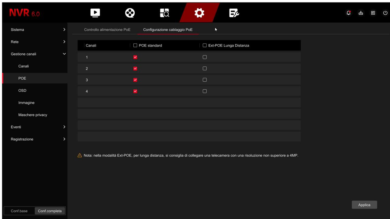
In questo esempio qui sopra vediamo l'impostazione di fabbrica di un NVR con 4 porte POE. I canali 1,2,3,4 sono collegati, con la spunta rossa, alle porte POE posteriori per le quali si prevede il cablaggio POE standard (distanza max 100 metri). Se, ad esempio, non utilizzi le porte POE 3 e 4 puoi togliere la spunta vicino a questi canali. Così i canali 3 e 4 saranno liberi per essere utilizzati con telecamere esterne.
