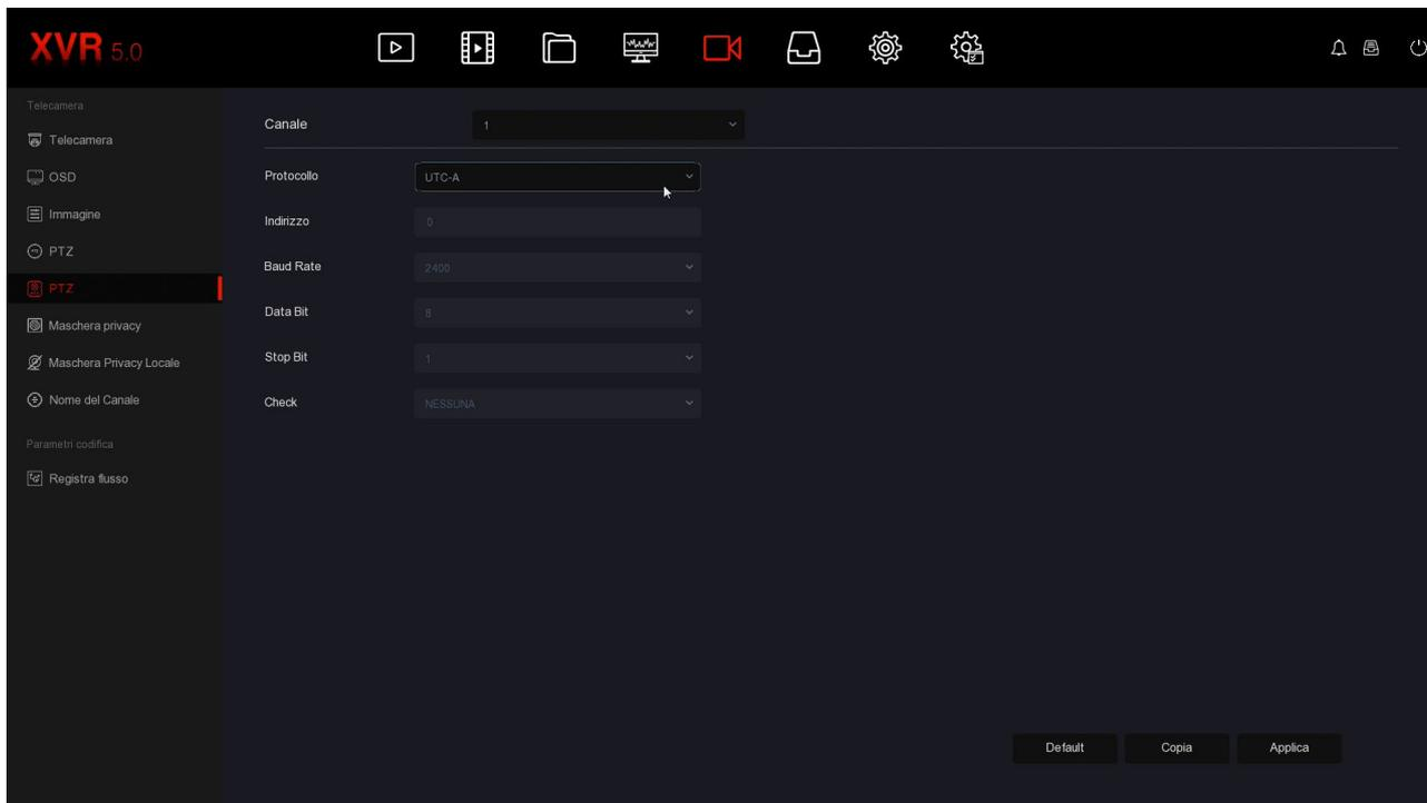
Per controllare il menu OSD della telecamera devi portare la telecamera a pieno schermo, cliccare per far comparire il menu del canale e poi scegliere PTZ per aprire il pannello di controllo PTZ.
