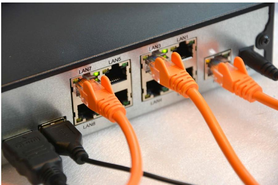
**ATTENZIONE** - A differenza degli altri DVR e NVR di questa gamma, gli NVR con porte POE sono forniti con un alimentatore speciale che fornisce **52VDC**. Fai attenzione a non scambiarlo per errore con un altro nostro alimentatore standard a 12VDC perché le uscite POE per le telecamere non funzionerebbero correttamente
