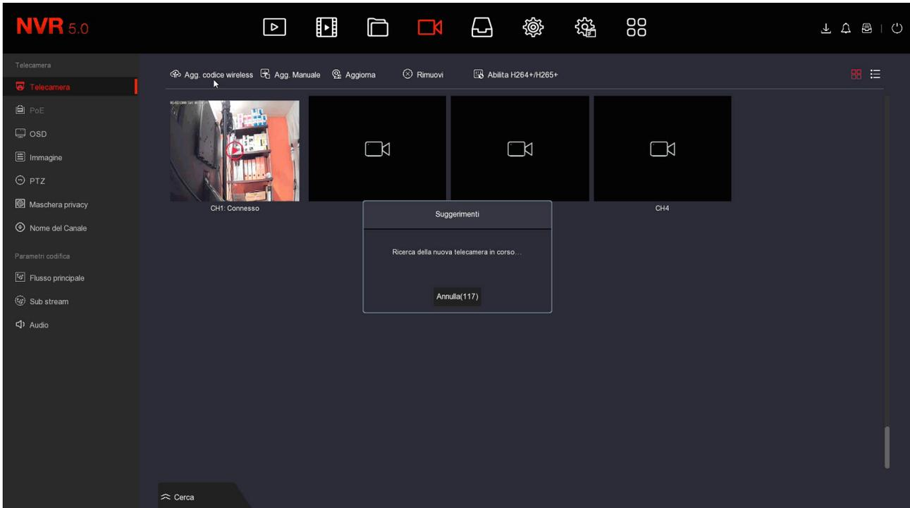
4 – Prima che scadano i 120 secondi, premi il pulsante presente fra le connessioni della telecamera, a fianco del connettore di alimentazione. Tieni premuto per 10 secondi fino a quando i LED della telecamera iniziano a lampeggiare.
