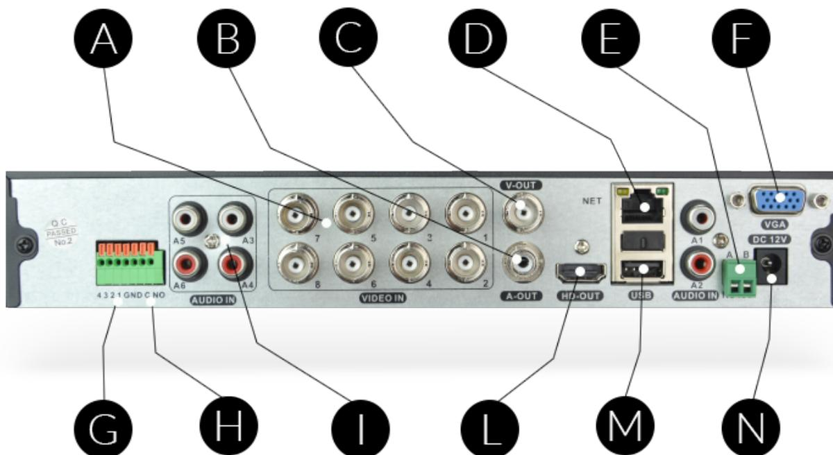
**A | VIDEO IN** – A questi ingressi video di tipo BNC puoi collegare qualsiasi tipo di telecamera analogica in tecnologia AHD, CVI o TVI, fino alla risoluzione massima gestita dal tuo modello di DVR. Puoi anche collegare vecchie telecamere analogiche CVBS. Le uniche telecamere con connessione BNC che non puoi collegare sono le telecamere digitali SDI.
