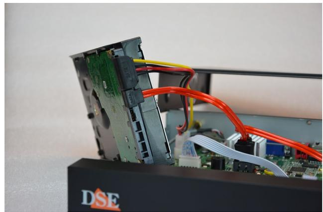
Collega l'hard disk con i due cavi di alimentazione e dati che trovi all'interno. Se ci sono più porte, scegli una coppia qualsiasi.
