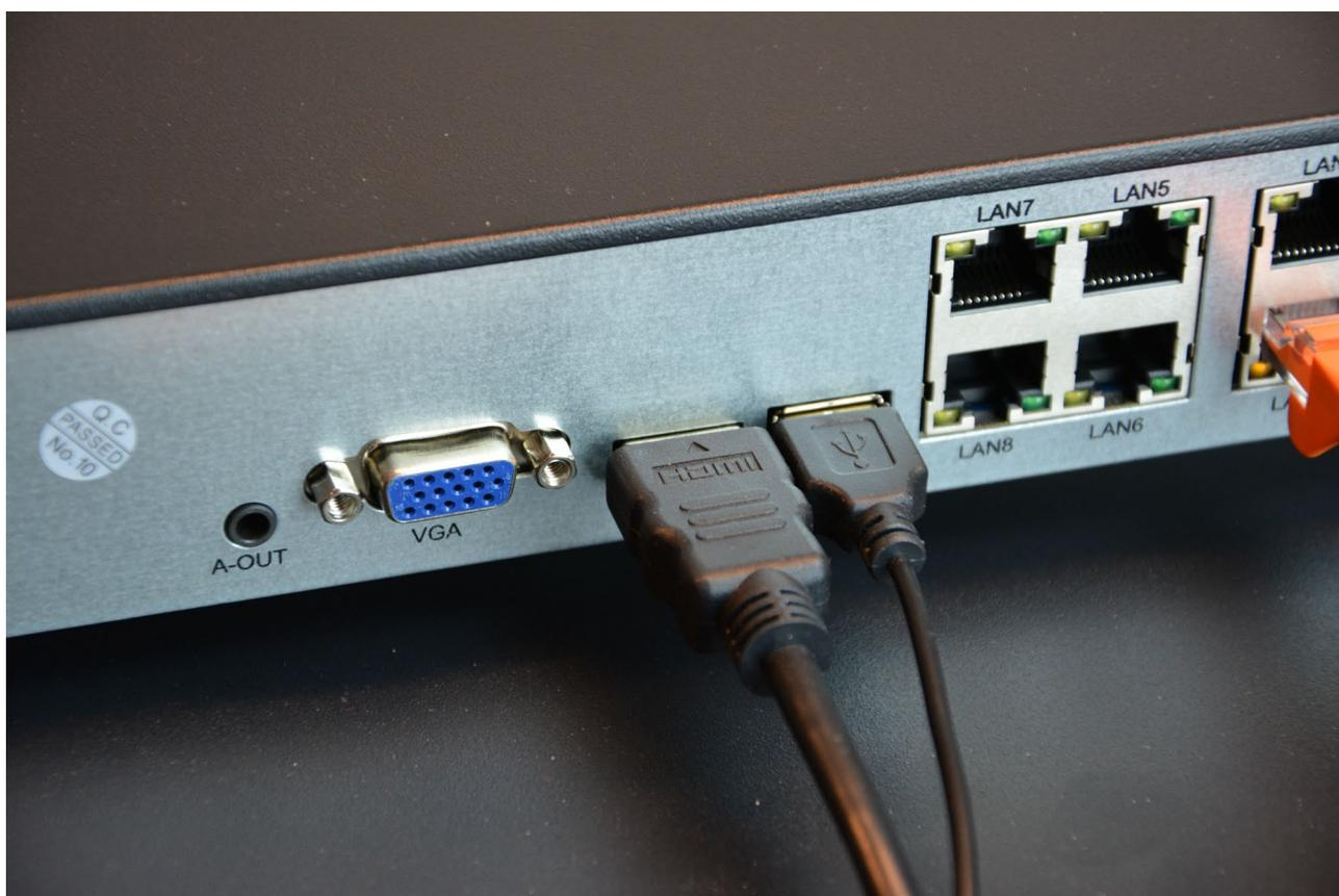
I DVR/NVR sono programmati di fabbrica per fornire una risoluzione bassa (1280x1024) in modo da essere compatibili con tutti i monitor. Una volta collegato il monitor e avviato il DVR/NVR ti conviene aumentare la risoluzione dell'uscita video fino alla massima supportata del tuo monitor (di regola FullHD 1920x1080 o 4K 3840x2160).
