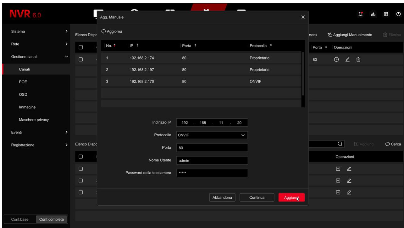
Qui sotto vedi la situazione finale di una telecamera RK collegata in plug and play con protocollo proprietario e una telecamera di altri costruttori collegata con protocollo onvif manualmente
