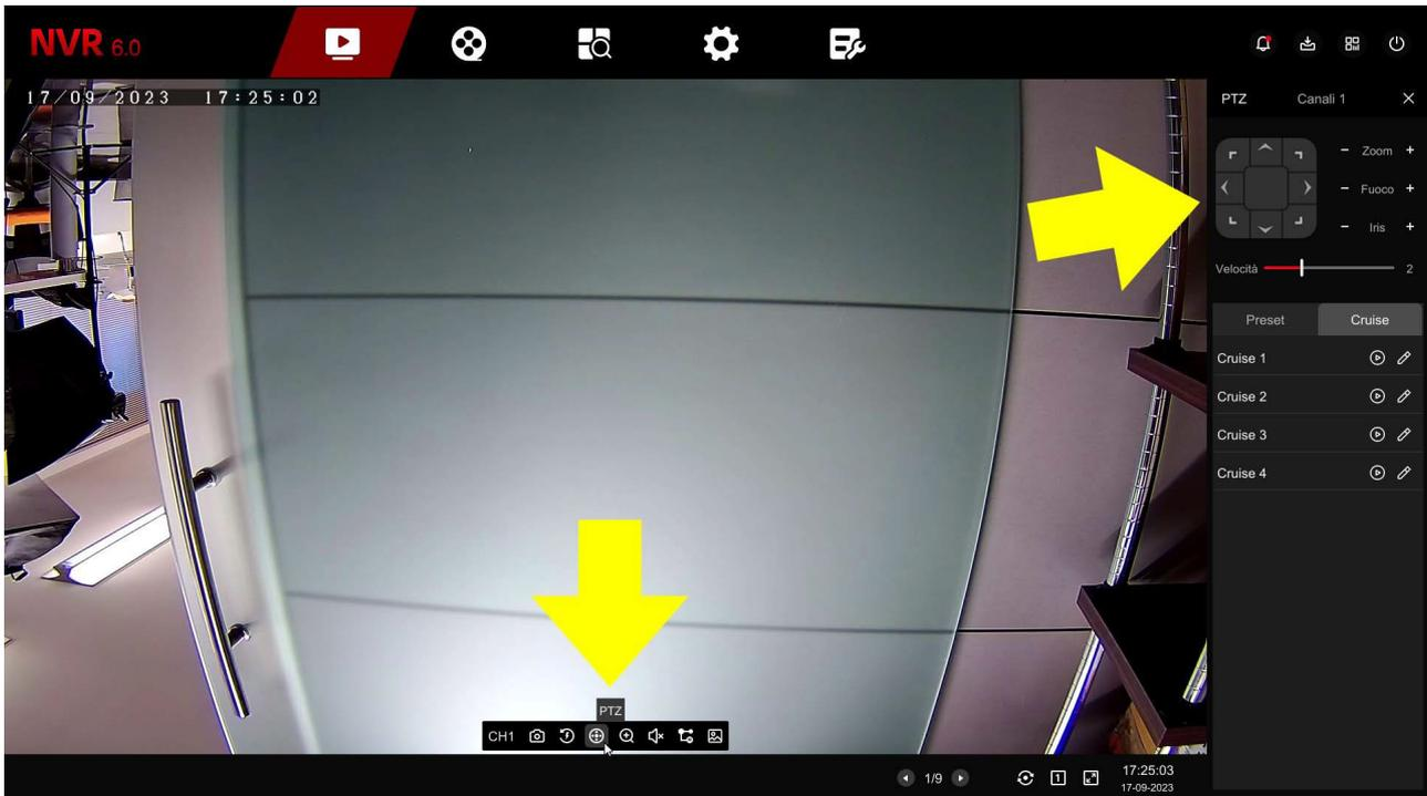
Puoi ruotare la telecamera con le frecce e comandare l'obiettivo con i pulsanti Zoom, Fuoco, Iris. Puoi anche richiamare e impostare i movimenti automatici preset e cruise. I comandi di questa finestra sono spiegati dettagliatamente nel manuale di configurazione.
