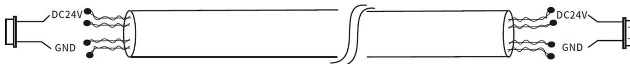
Per collegare questi dispositivi non devi utilizzare cavo sottili, sotto 0,5 mmq o cavi non in rame puro, perché introdurrebbero una elevata caduta di tensione e potrebbero non consentire il buon funzionamento dell'apparecchiatura collegata.
