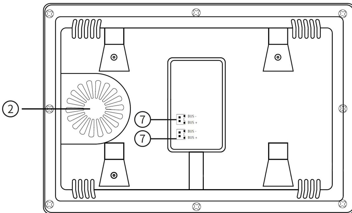
I due connettori sono internamente collegati fra loro, per cui non esiste alcuna differenza fra usare uno o l'altro. Vi sono 2 connettori per rendere più facile il collegamento di un secondo monitor a valle, senza dover predisporre un morsetto esterno.
