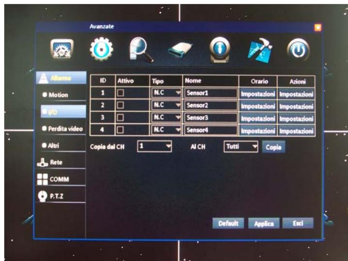
I DVR serie DH sono in grado di generare un allarme in caso di azionamento degli ingressi posteriori che si possono collegare a contatti, sensori etc. intrusione.
