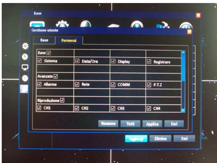
Di fabbrica sono abilitate tutte le operazioni. E' possibile impedire l'accesso togliendo la spunta dalle funzioni che si vogliono interdire all'utente. L'elenco riporta sia le schede della programmazione sia le funzioni operative del DVR.
