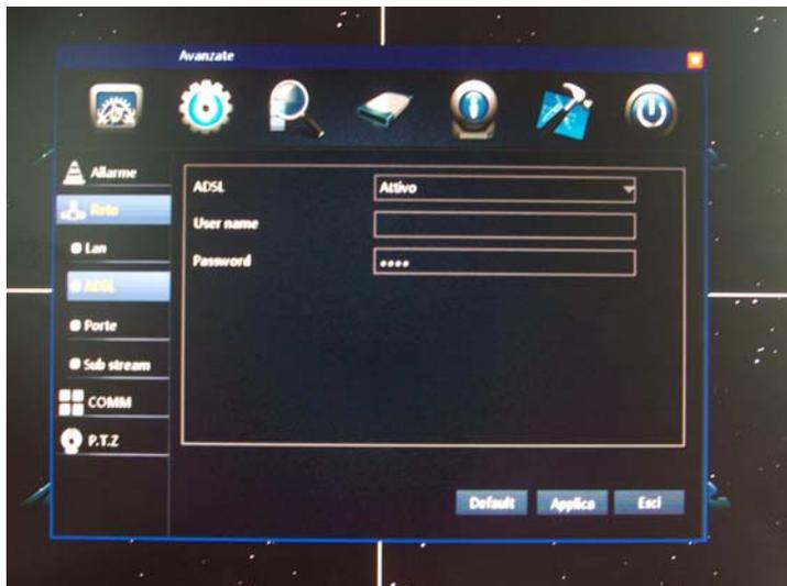
E' possibile collegare i DVR direttamente a un modem ADSL senza realizzare una rete, in quanto sono in grado di gestire il protocollo PPPoE per il log-in. In questa pagina è possibile inserire il nome utente e la password per il log-in richiesti dal provider ISP.
