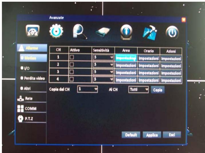
I DVR serie DH sono in grado di analizzare le modifiche dell'immagine ripresa e generare un allarme in caso di intrusione. Questa funzione si definisce comunemente MOTION DETECTION.
