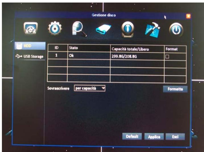
In questa sezione si gestiscono il o i dischi rigidi che avrete avuto cura di inserire all'interno del DVR seguendo le istruzioni del manuale di installazione. La tabella indica tutti i dischi presenti. Se non visualizzate il disco controllatene i collegamenti (dati e alimentazione) e l'integrità.
