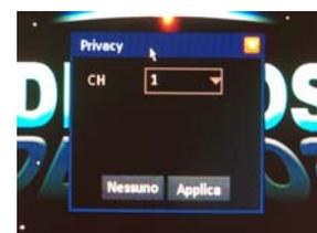
una piccola finestra dove si sceglie il canale su cui operare ed è possibile definire le aree di mascheramento trascinando il mouse nello schermo. Per eliminare le maschere create premere NESSUNO. E' possibile definire fino a 4 maschere per ogni telecamera.
