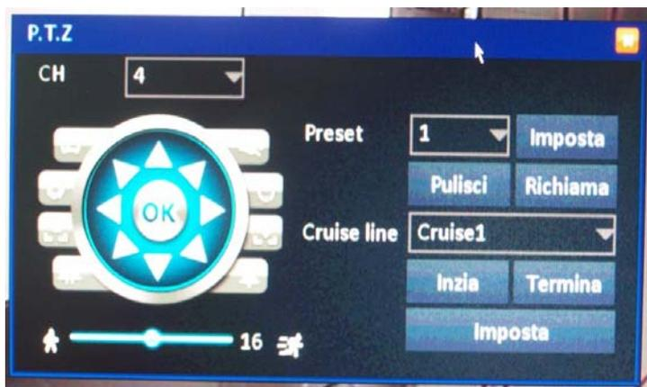
Occorre scegliere la telecamera ed agire sui pulsanti di comando a sinistra per regolare spostamenti, zoom, fuoco e iris. La regolazione da 1 a 16 in basso a sinistra permette di scegliere la velocità di spostamento. Nel pannello a destra è possibile impostare e richiamare i preset (preposizionamenti) ed i principali movimenti automatici.
