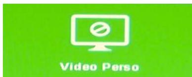
Gli NVR/DVR serie DN sono in grado di generare allarmi nell'eventualità che il segnale video di una telecamera cessi di pervenire al NVR.
