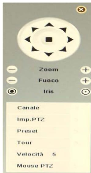
Prima di poter agire sui pulsanti di comando è necessario impostare il metodo di controllo delle telecamere PTZ come spiegato più avanti nel manuale. I videoregistratori sono in grado di controllare sia telecamere PTZ IP, tramite il protocollo onvif, che telecamere analogiche/AHD locali, tramite la porta RS485 e protocollo Pelco D.
