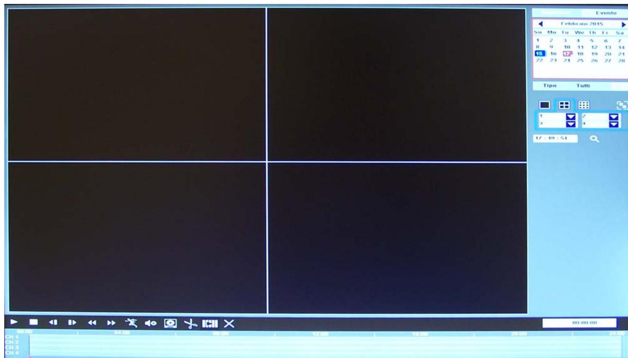
In questa finestra è possibile ricercare le immagini registrate ed archiviate nel videoregistratore. Il numero di canali riproducibili simultaneamente varia in base al modello e all’opzione di multitecnologia selezionata. A destra è possibile impostare i parametri della ricerca che dall’alto verso il basso sono:
