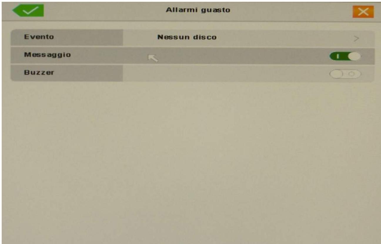
E' possibile generare delle segnalazioni in caso di mancanza disco, errore di scrittura su disco e esaurimento spazio su disco. Si possono abilitare l'azionamento del buzzer (BUZZER) e l'indicazione a schermo (MESSAGGIO).
