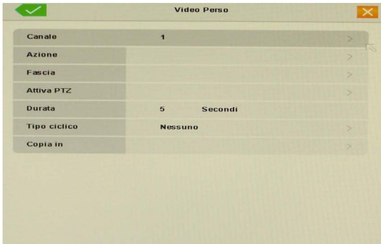
Le azioni di allarme che si possono impostare per il video perso sono le stesse già viste per l'allarme motion ad eccezione della registrazione.
