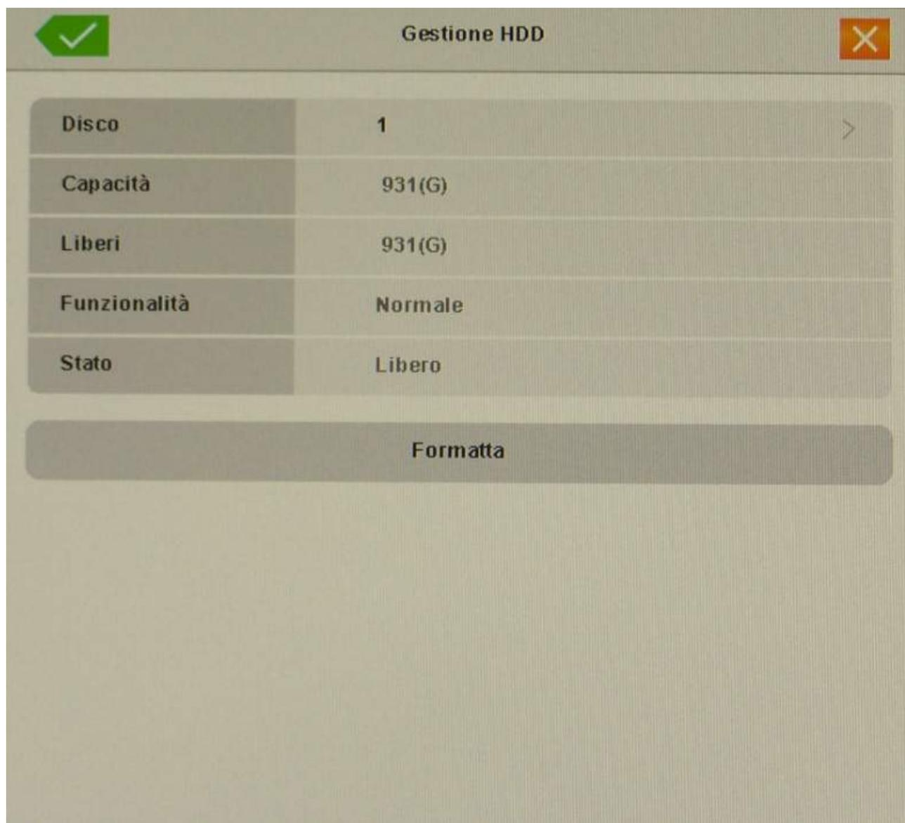
In questa finestra trovate gli hard disk inseriti nel NVR/DVR e potete effettuare la formattazione fisica premendo il pulsante FORMATTA. Se l'hard disk che avete inserito non risultasse elencato nella tabella verificatene il cablaggio e il funzionamento.
