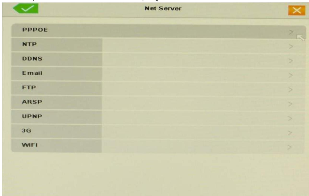
PPPOE – E' possibile collegare il videoregistratore direttamente a un modem ADSL senza realizzare una vera e propria rete, in quanto esso è in grado di gestire il protocollo PPPoE per il log-in diretto. Premendo il pulsante Impostazioni è possibile inserire il nome utente e la password per il log-in richiesti dal provider.
