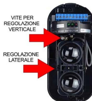
Come prima cosa occorre fare un allineamento ottico agendo sia sul ricevitore che sul trasmettitore per poi procedere con l'affinamento con il tester.
