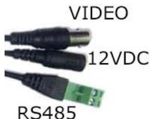
**Uscita video BNC** – Al connettore BNC femmina a baionetta si collega il cavo video che si porta poi verso monitor o dispositivi di gestione in genere tramite cavo coassiale tipo RG59 e connettore BNC.
