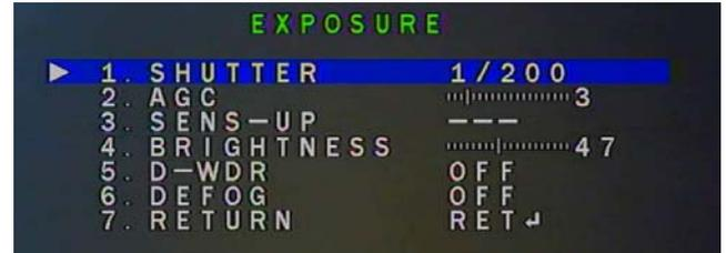
Il settaggio di fabbrica di questo parametro è di 1/400 ed è possibile mantenerlo invariato fino a velocità dei mezzi inferiore a circa 120 Km/h.
