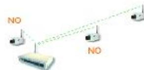
▶ Per evitare interferenze, ponete antenna e ricevitore in posizione rilevata in modo che non vi sia movimento fra le antenne (es. passaggio di persone o mezzi).
